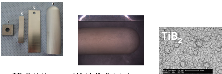
TiB 2 Schichtungen auf Molybdän Substrat, 700 °C, LiF-KF-NaF geschmolzene Elektrolyt
