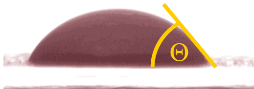
Kontaktwinkel 50 ° (Sessile-Drop Methode)
