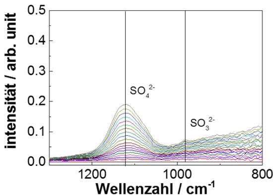
*Entwicklung von sulfidisch- und sulfatischen Korrosionsprodukten auf einer Zinkoberfläche. Bewitterung bei 80 % RH und Raumtemperatur. Messung alle 15 min, man erkennt ein stetiges Bandenwachstum.*
